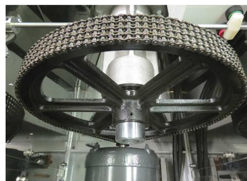
**Transmission par chaîne quadruple**
