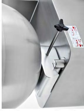
Vitesse de rotation de la cuve réglable par frein en modèles E
