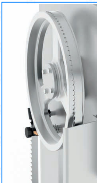
Poulies en acier inoxydable avec double rebord. Stainless steel pulleys with double rim.
